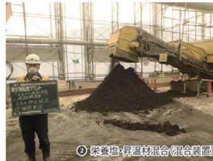
2 栄養塩・昇温材混合(混合装置)
