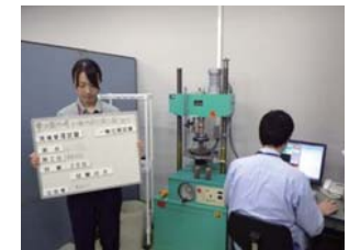
改良部の強度確認
