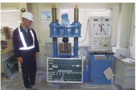
改良部の強度確認
