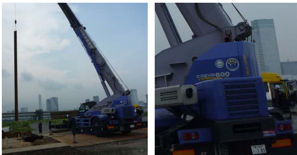
写真-5.3 排ガス対策型、低振動型重機の使用状況
