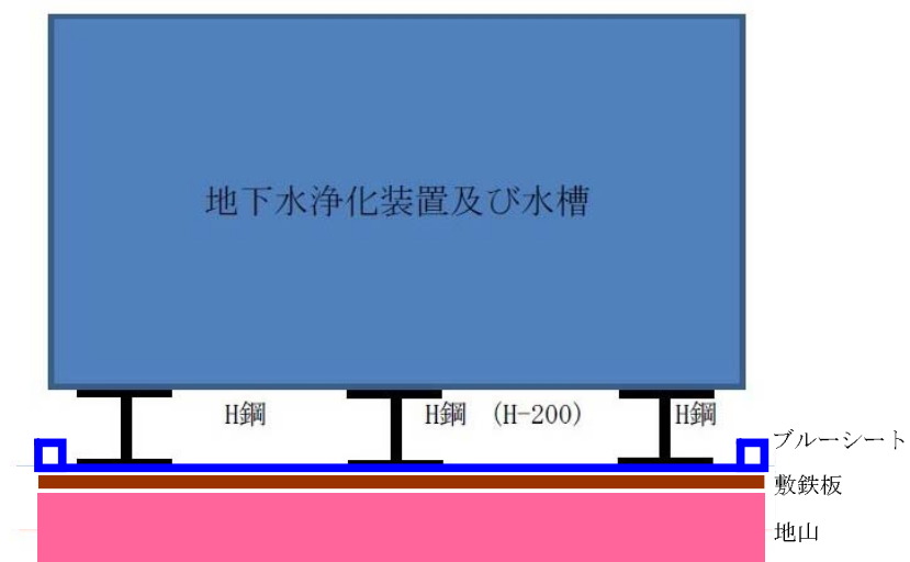
図-3.4 プラント養生状況図
