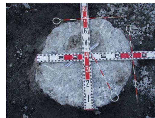
静的締固め固化改良体 造成状況
