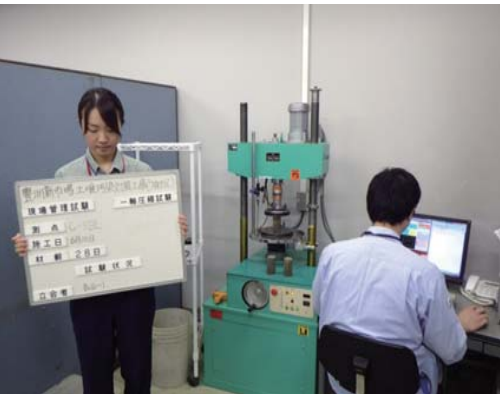
改良部の強度確認
