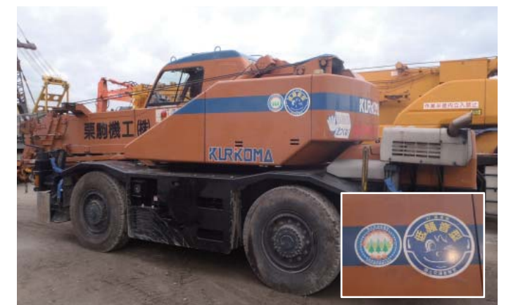
クレーン車 (低騒音型認定、排ガス対策型認定)
