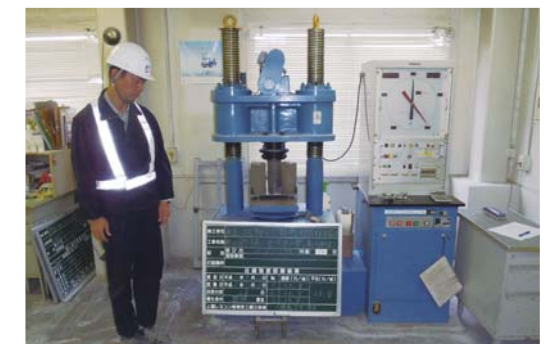
改良部の強度確認
