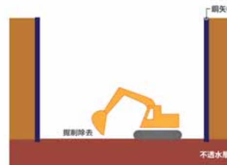
掘削除去による対策完了の確認
