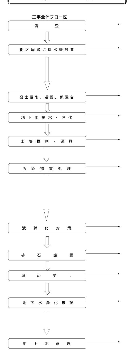
案-5: 円 工事全体フロー図 調 查 街区周縁に遮水壁設置 盛土掘削、運搬、仮置き 地下水揚水・浄化 土 壌 掘 削 ・ 運 搬 汚 染 物 質 処 理 化 液 状 対 策 置 砕 石 設 埋 め 戻 し 地下水浄化確認 地 下 空 間 利 用 地 下 水 管 理
