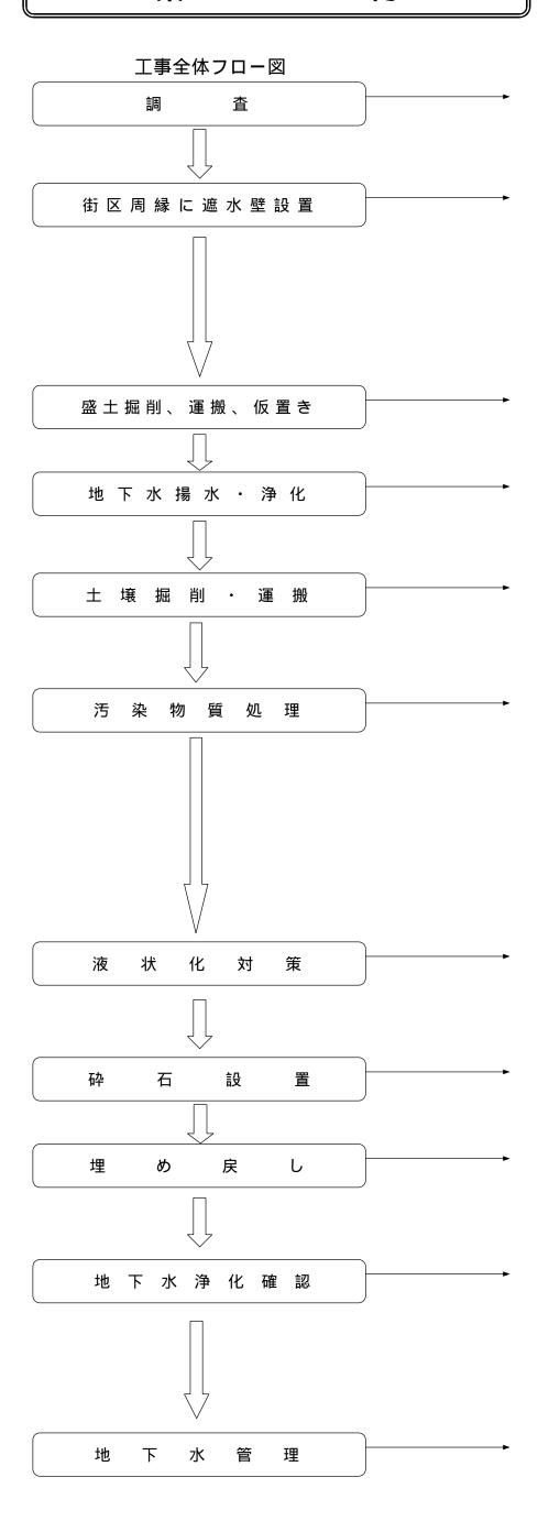
工事全体フロー図 查 調 街区周縁に遮水壁設置 盛土掘削、運搬、仮置き 地 下 水 揚 水 ・ 浄 化 土 壌 掘 削 ・ 運 搬 汚 染 物 質 処 理 液 化 状 対 策 設 砕 石 置 埋 め 戻 し 地下水净化確認
