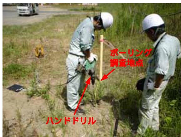
ハンドドリルによるガス採取孔の設置状況
