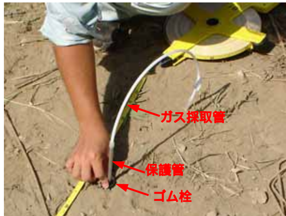
保護管及びガス採取管の挿入状況
