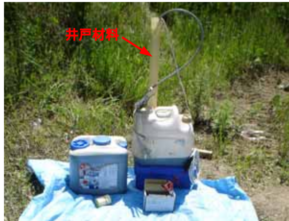
観測井の洗浄の状況
