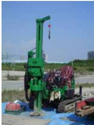
低騒音急速削孔機
