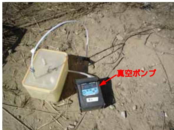
真空ポンプによる孔内ガスの吸引採取の状況
