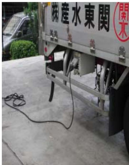
外部電源供給設備を使用中のトラック
