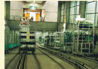
自動搬送設備
