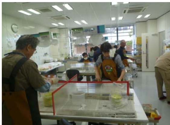
前処理後の検体を ゲルマニウム半導体検出器のサンプル容器に入れているところ
