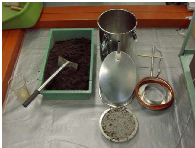
図-2.4 小型堆肥化実験装置からの試料採取状況
